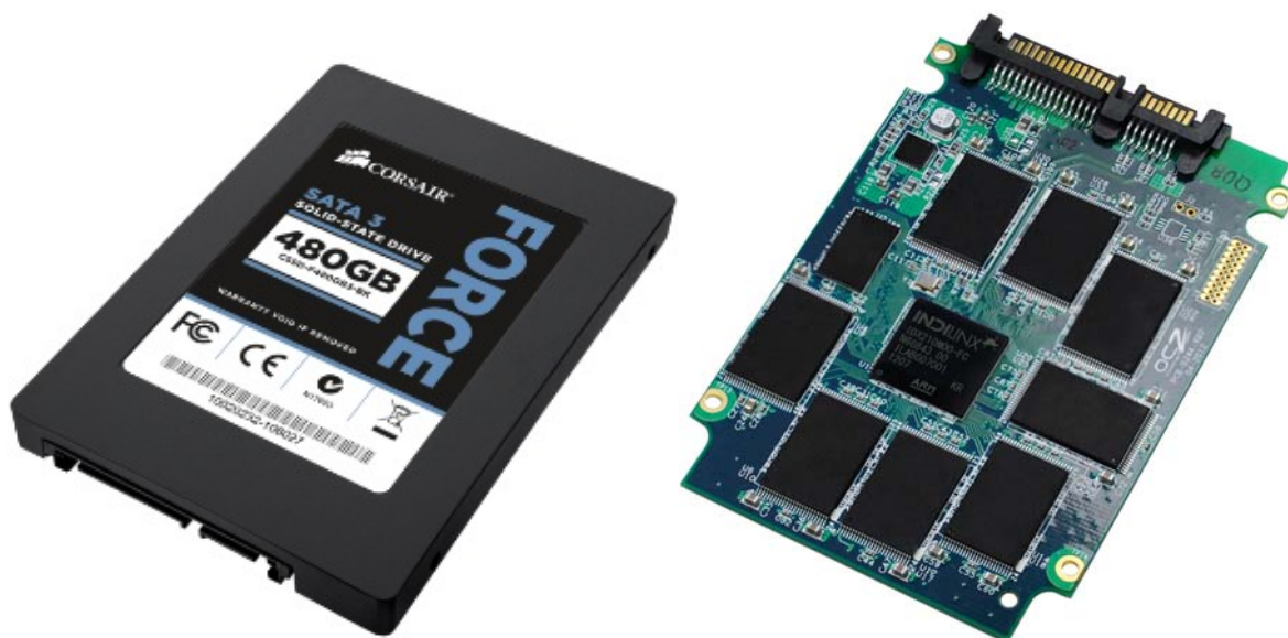
Obr.: SSD disk + pohled na jeho vnitřní část (velikost 2,5", kapacita 480GB, rozhraní SATAIII, čtení 550 MB/s, zápis 520 MB/s)
