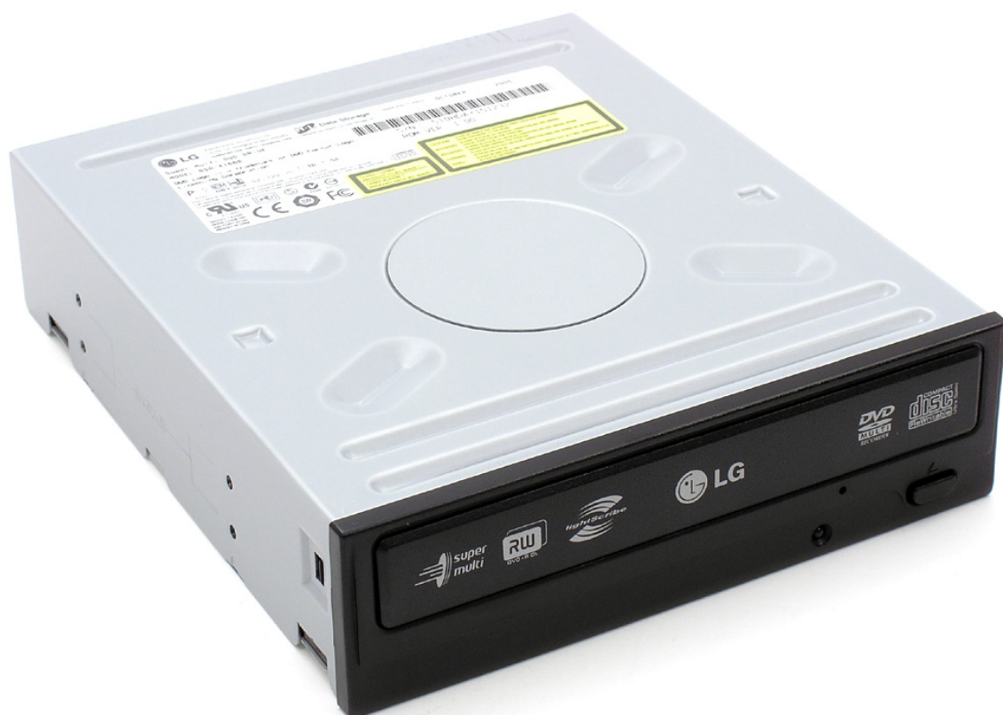
Obr.: Př. DVD mechaniky (z uvedených značek lze vyčíst, že mechanika umí zapisovat na všechny disky CD a DVD, pravděpodobně s výjimkou DVD-RAM, a také umí vypalovat potisk technologií LightScribe)
