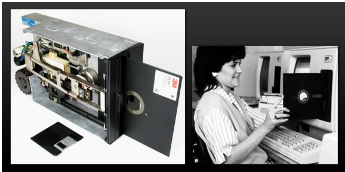
Obr.: Disketová mechanika s disketou velikosti 8"
