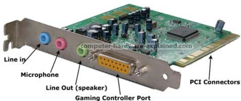
Obr.: starší typ zvukové karty (pouze analogové výstupy)
