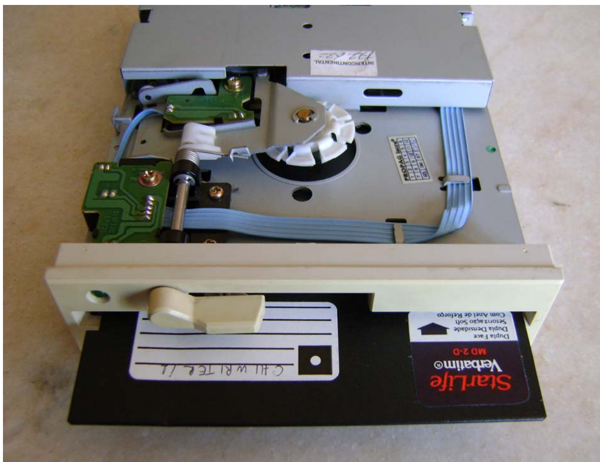
Obr.: Disketová mechanika s disketou velikosti 5,25"
