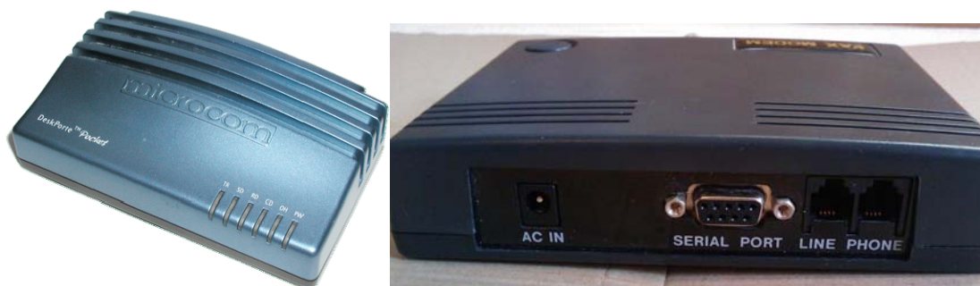
Obr.: Příklad externího modemu (propojení s PC pomocí seriového portu RS232)
