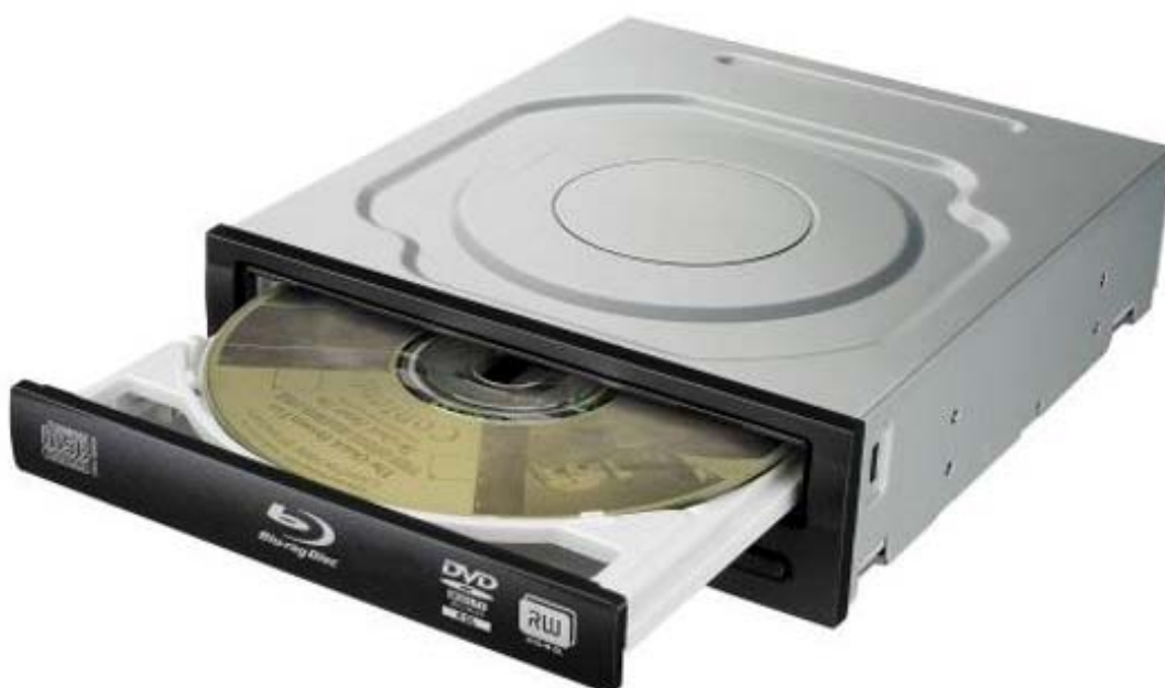
Obr.: Př. Blu-ray mechaniky (z uvedených označení je vidět, že mechanika je zpětně kompatibilní i s disky CD a DVD).
