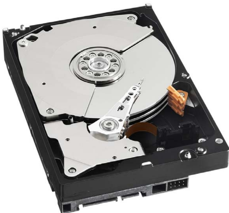
Obr.: Jeden z posledních pevných disků společnosti Western Digital (kapacita 4TB, rozhraní SATAIII, 7200rpm)
